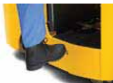
Передвижение и подъем груза прекращаются, если оператор покидает кабину.
