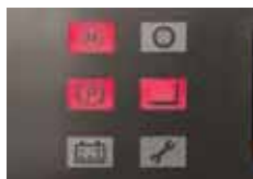
Блокировка работы подъемника выводится на дисплей системы контроля.
